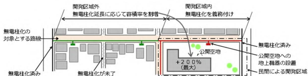
図 13-2 都市開発諸制度を活用した無電柱化の取組イメージ
