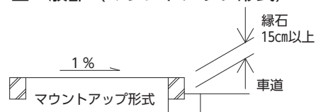
【図4.2】横断歩道部における構造
