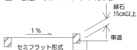
【図4.1】横断歩道部等の段差(車乗り入れ部を除く)
