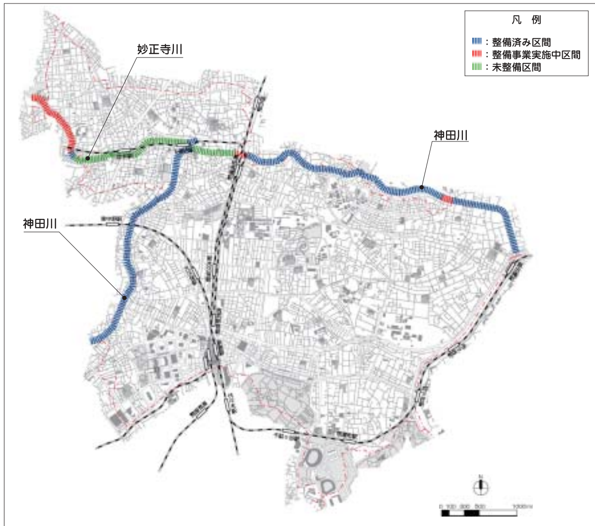
■図－50mm/h降雨対応に向けた河川改修の状況（平成19（2007）年6月現在）
