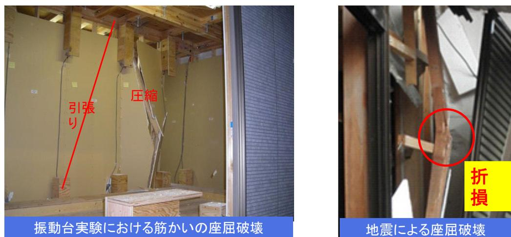
図1-22 筋かいの座屈破壊
