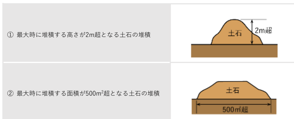
図5 許可を要する工事（土石の堆積）
