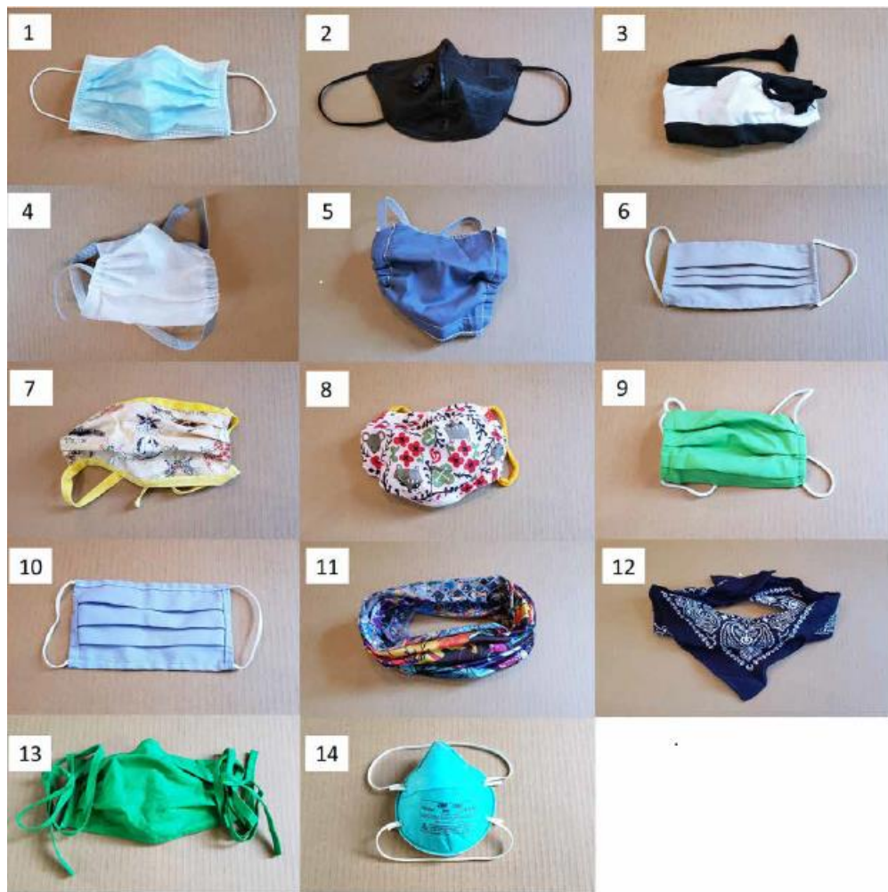
1: サージカルマスク 2: バルブ式N95 3: 手作りマスク 4: 不織布マスク etc.
