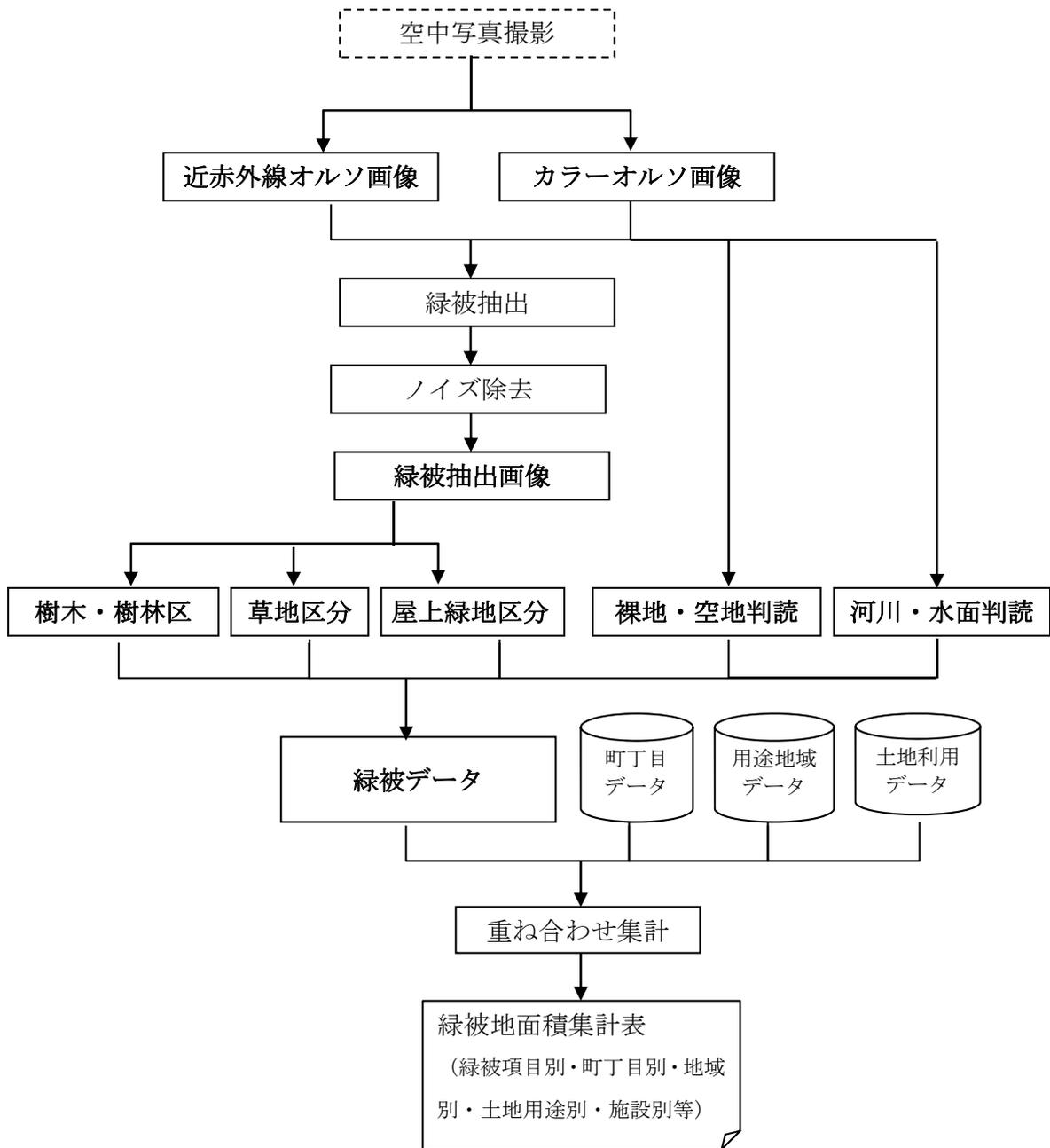
図 1-4 空中写真判読の調査のフロー図
