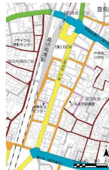
【地区内の道路幅員の現況】
