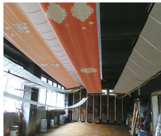
両端から引いた状態で作業と乾燥を行う
