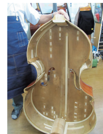
内部を縦に通るバスバー。音の振動を表板に伝える
