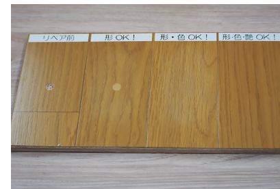
リペア前→パテ埋め→色形補正→完成
