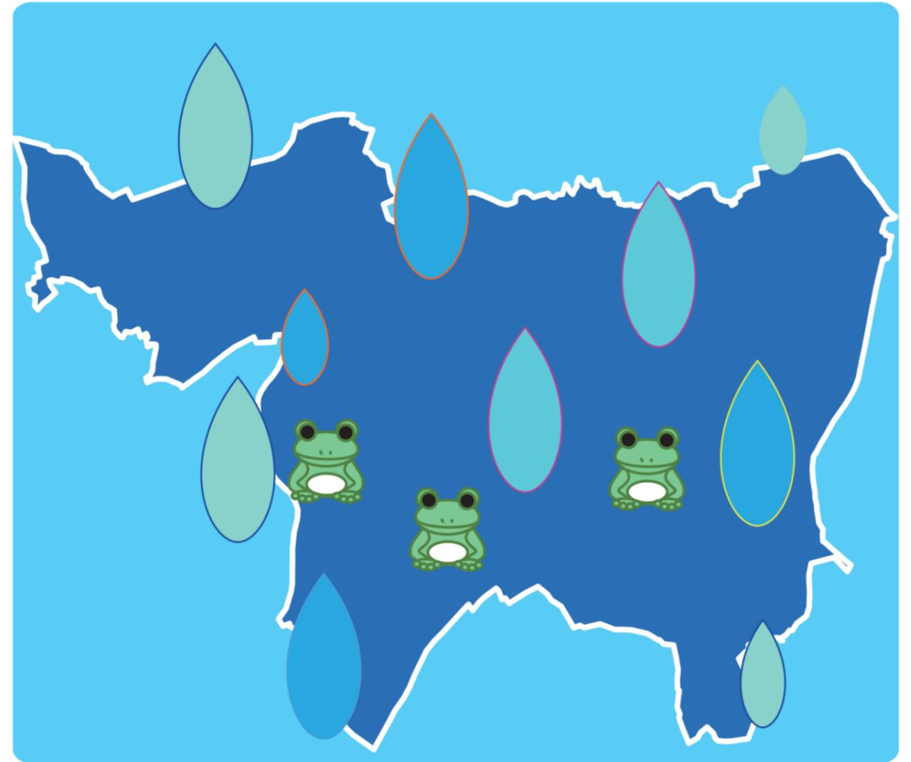
都市化により雨水が地面に浸透する面積が減少し、下水道施設や河川への負担が大きくなっています。
