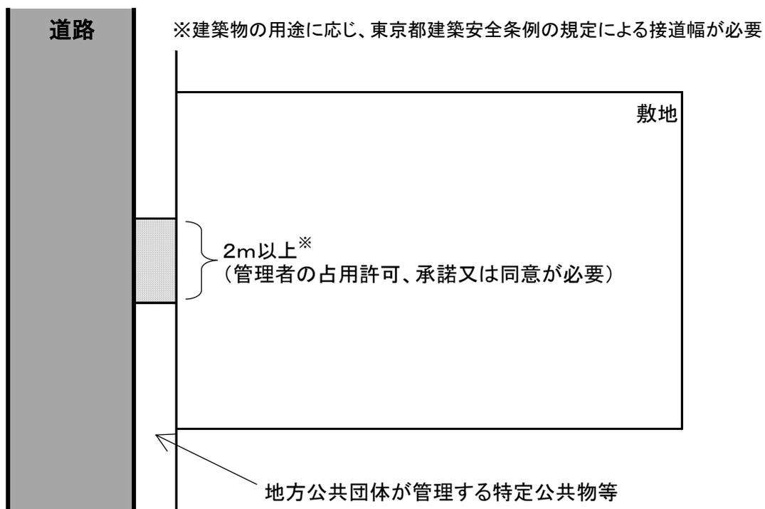
建築基準法施行規則第10条の3第4項第2号及び第3号に関する基準 概念図(参考)
