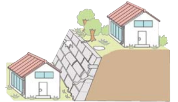
▲擁壁に亀裂や膨らみがないか、樹木の根などが擁壁に悪い影響を与えていないかなど点検をしましょう
