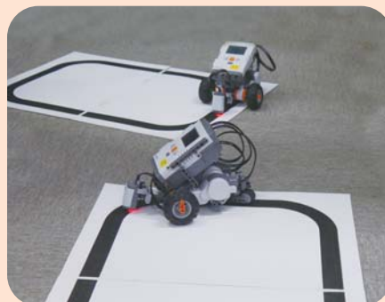
▲光センサーを使い、黒く塗られたライン上を正確に走るロボット
