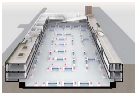
基礎下免震層
