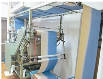
通常は湯のし機で作業をしますが特別な生地は手で湯のしをします
