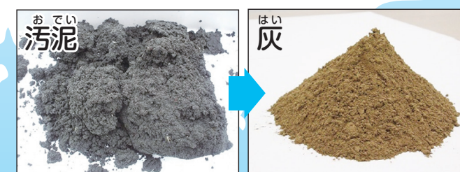
脱水した汚泥を焼却して灰にします。
