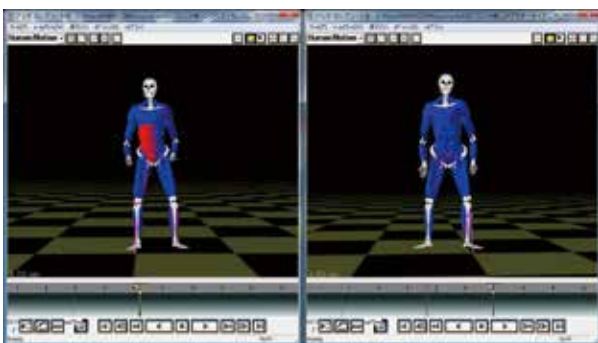
ARMO®によるボードを抱える作業の動作解析。右がステイ着用時で、赤い部分(負荷を示す)が減っている
