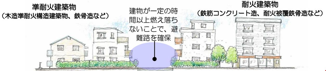
耐火建築物とは : 主要構造部(壁、柱、屋根、床、階段など)を耐火構造とした建築物
