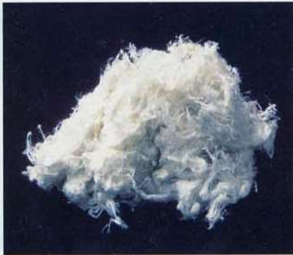
▲白石綿(クリソタイル)
