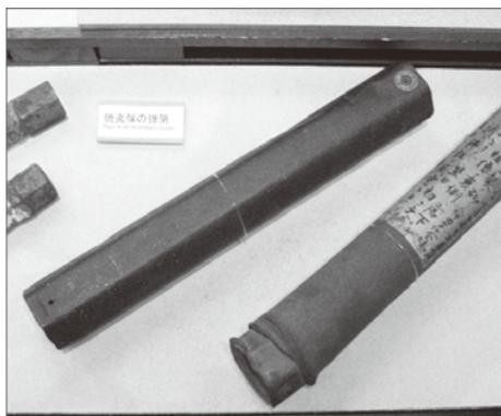
油脂焼夷弾の弾筒 (写真中央) 右上の丸い所が信管
