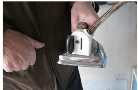
◆鉄の板を抜き差ししてスイッチを切り替える
