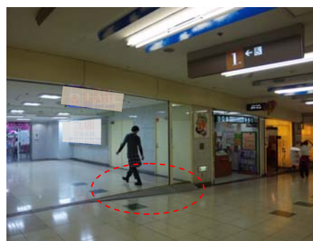
出入口に段差が生じた場合でも、スロープですりつけることで安全に通行できる
