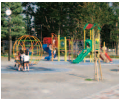
西落合公園 公園の周囲が高くなっている公園自体が調節池になる
