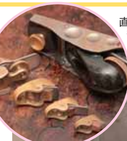
直線のないコントラバスは何種類ものカンナを使い分けて丁寧に削ります
